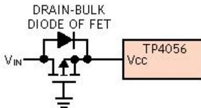
图 5: 低损耗输入反向极性保护
